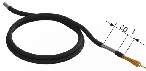
Obraz 25 EMC kábel odizolujte pred pripojením na svorkovnicu kábla v dĺžke 30 mm. Rozmer „t“ podľa približnej vzdialenosti od upevňovacej príchytky k svorkovnici kábla
