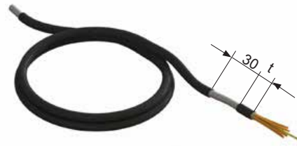
Figure 25 Afisolér EMC-kablet på 30 mm inden det tilsluttes på kabelklembrættet. Mål „t“ svarer til ca. afstand fra monteringsbøjlen til kabelklemmen.
