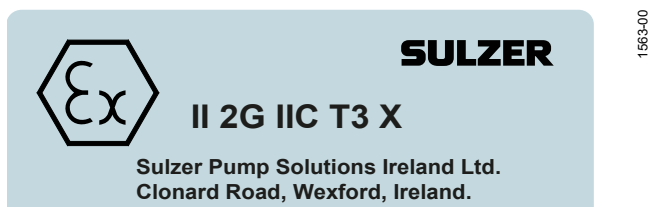
Figura 6. Etiqueta adhesiva de seguridad frente a explosiones
