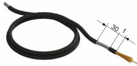
Bild 25 EMC Kabel vor Anschluss an dem Kabelklemmbrett auf 30 mm abisolieren. Maß „t“ entsprechend dem cirka Abstand von der Befestigungsschelle zur Kabelklemme
