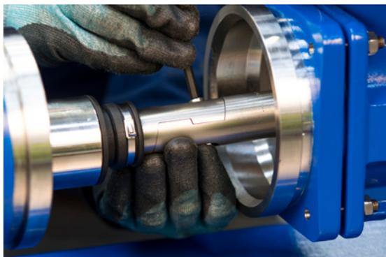
5. Il sistema di accoppiamento "split coupling" è fissato con viti
