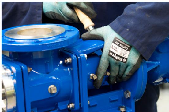
1. Una volta smontati rotore e statore si potrà operare sulla trasmissione
