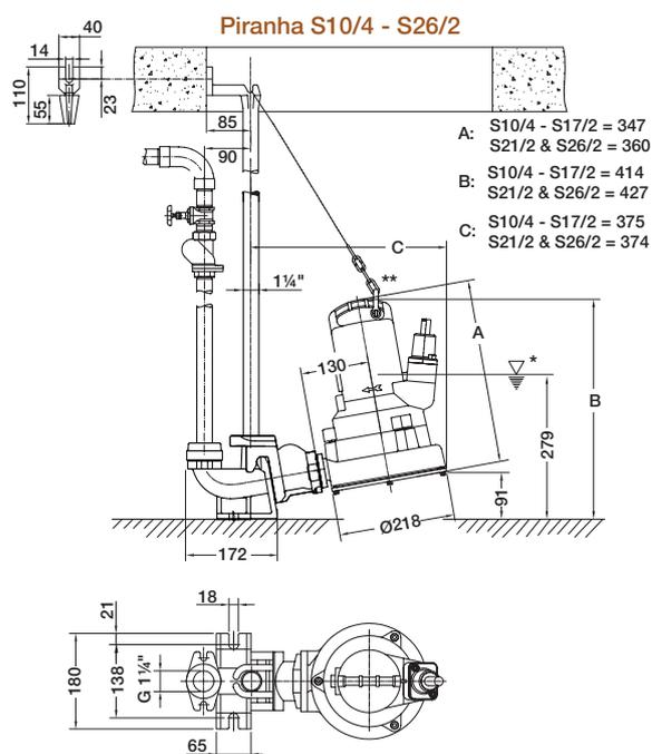
\* Livello minimo di arresto in funzionamento automatico (sensori di livello). Apertura minima pozzetto Ø 625 mm. Basamento fissato utilizzando tasselli M10, foro di posizionamento diam. 14 mm.
