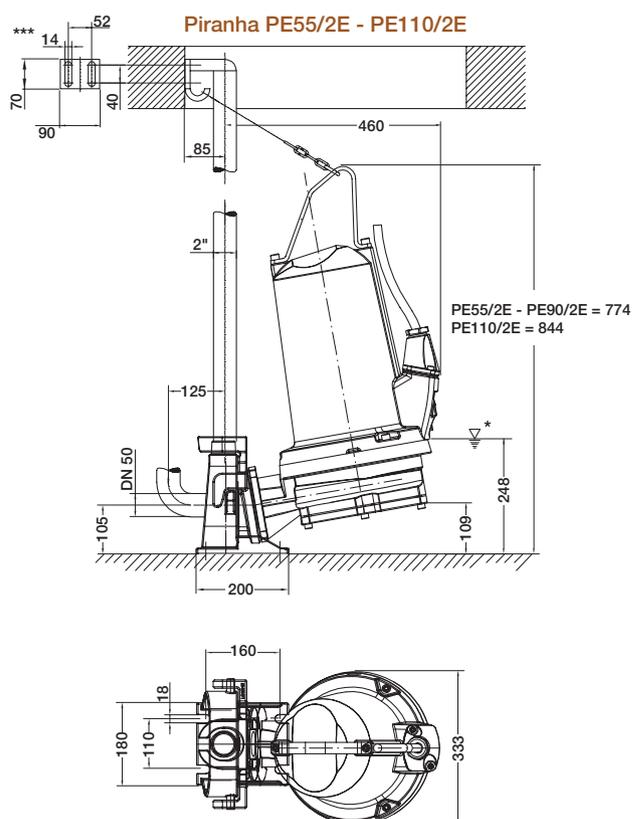
\* Livello minimo di arresto in funzionamento automatico (sensori di livello). Apertura minima pozzetto  $\varnothing$  625 mm. Basamento fissato utilizzando tasselli M10, foro di posizionamento diam. 14 mm.
